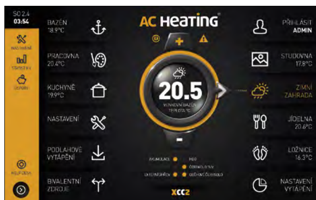
▲ Obr. 4 ● Chytrý řídicí systém xCC, vyvinutý firmou AC Heating, se umí individuálně přizpůsobit objektu a vytápění řídí i podle počasí a spotového trhu s elektřinou
