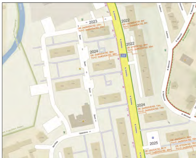
▲ Obr. 3 ● Rekonstruované přípojky tepelných rozvodů – potrubí NRG FibreFlex
